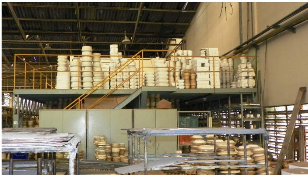
Foto 30. Moldes de gesso para a produção de travessas e tigelas
